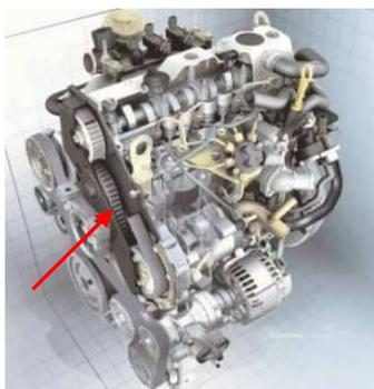
Un moteur à combustion interne effectue lors de son fonctionnement différentes phases réalisées dans un ordre précis appelées « temps ». Afin que ces temps se déroulent d'une manière ordonnée, il est nécessaire de synchroniser les différentes phases. La distribution est le système mécanique qui va synchroniser ces phases : c'est à partir du mouvement du vilebrequin que ce système est mu.
