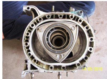
Vue du moteur rotatif. La RX7 est équipée d'un birotor et de 2 turbos
